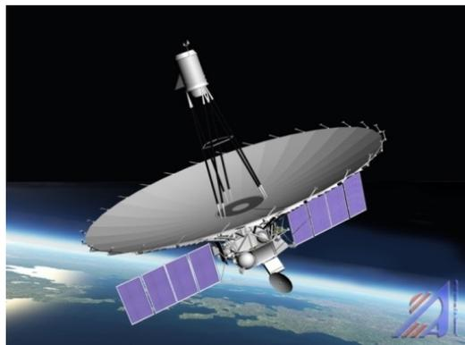
Интерферометр «Радиоастрон» запущен 18.06.2011 г. Космический радиотелескоп: диаметр 10 метров. База Земля – космос до 350 000 км. Рабочие частоты: 0.3, 1,6, 5, 22 (18-25) ГГц. В кооперации работают 29 наземных радиотелескопов.
